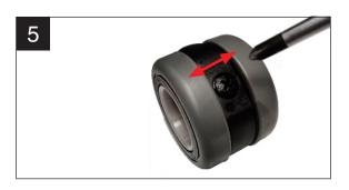
Si nécessaire, vous pouvez régler la résistance de roulement de chacune des roulettes : ôter les roulettes du piètement puis tournez la vis située sur la partie inférieure de la roulette à l'aide d'un tournevis cruciforme vers la gauche (plus dur) ou vers la droite (plus souple). Remettre ensuite les roulettes en place.
